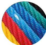
Les cordages et filets en polypropylène Ø 16 mm sont renforcés avec du câble d'acier.
